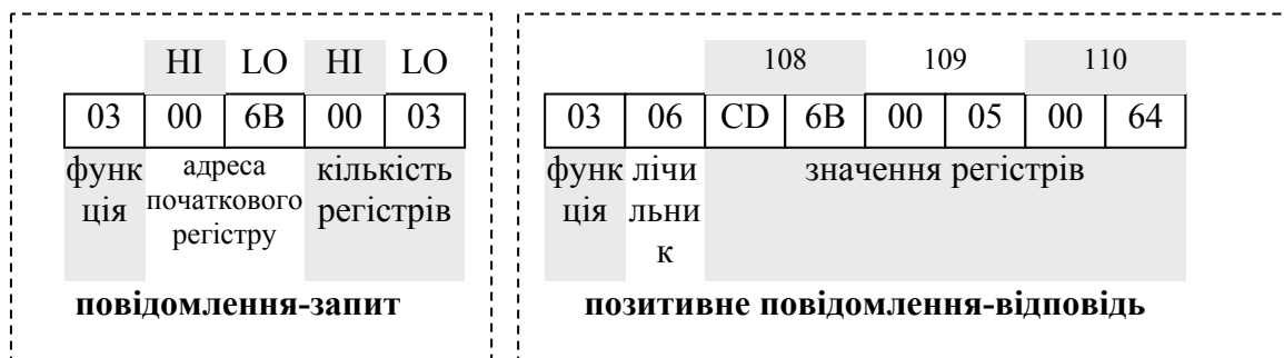
Рис.26. Формат повідомлень для запиту читання значень вихідних/внутрішніх регістрів
